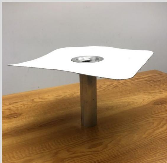
Ce modèle de drain peut aussi être fabriqué pour recevoir les crépines de drain Procast et Duo-Procast. Les crépines sont retenues en place par la tige filetée et le boulon de serrage sur le dessus. La tige est vissée dans un écrou serti, semi-hexagonale (rivet), centré sur l'attache métallique. Cette attache est agrafée à l'anneau de serrage lors du montage en usine.
