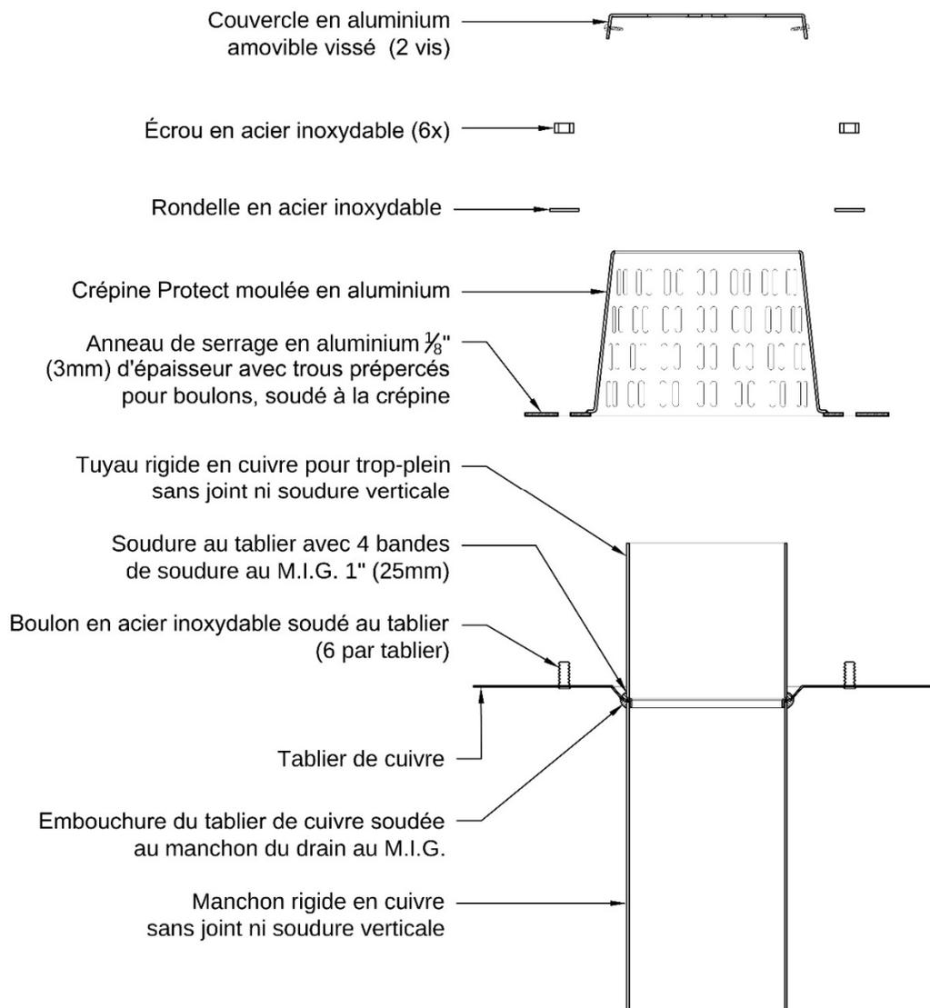
DESSIN TECHNIQUE : détail de construction typique, DRAIN TROP-PLEIN
