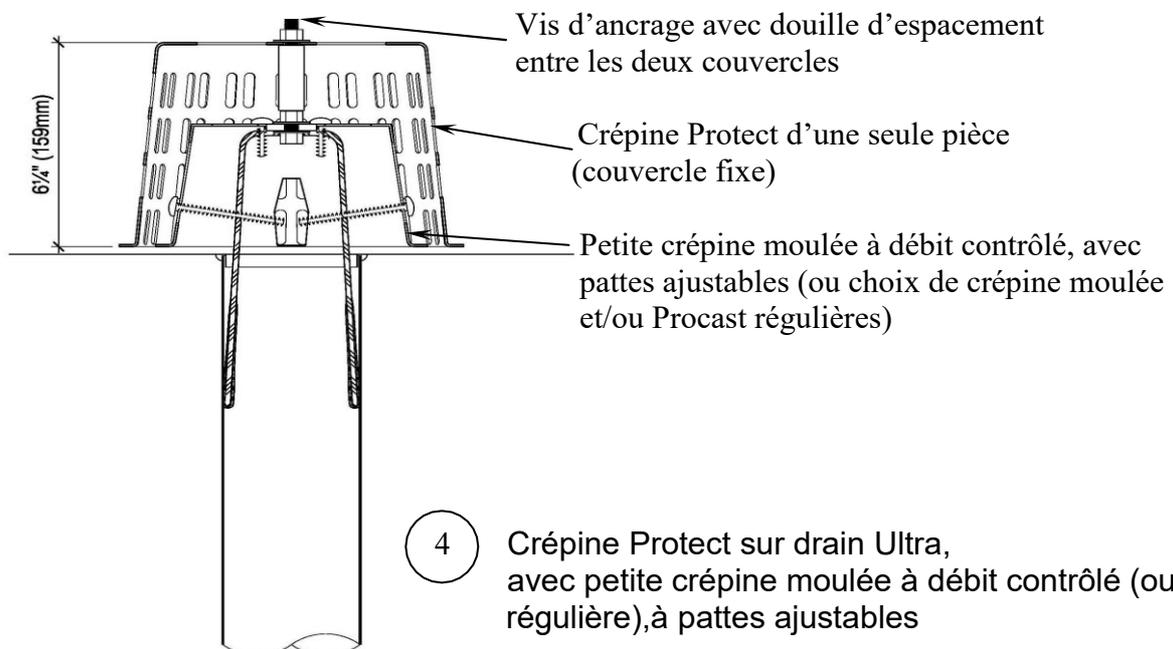
\* ou autres modèles avec crépine ancrée à la bride du drain (voir tableau d'installation)
