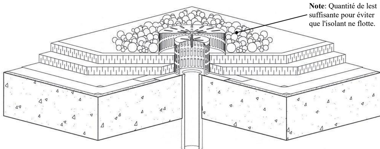
Pour les recommandations d'installation au niveau de la membrane ainsi que le raccordement à la colonne pluviale, veuillez vous référer aux fiches techniques du drain *Murphco Ultra\**.
